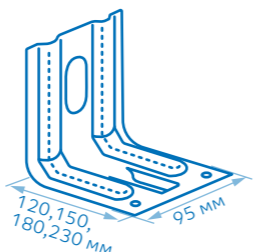
КРЕПЁЖНЫЕ КРОНШТЕЙНЫ УСИЛЕННЫЕ ККУ-90 (120,150,180,230) с шайбой и изоляционной прокладкой, t=1,2 и 2,0 мм
