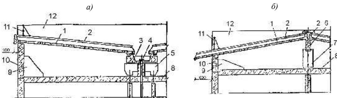
*a – с внутренним водоотводом; б – с неорганизованным водоотводом; 1 – железобетонная кровельная панель; 2 – железобетонный П-образный нащельник; 3 – железобетонный водосборный лоток; 4 – водосточная воронка; 5 – подкладочная балка под лоток; 6 – опорная балка; 7 – опорный столик; 8 – утепленная панель перекрытия; 9 – треугольный анкерный элемент; 10 – опорная фризовая панель; 11 – ограждение крыши; 12 – торцовая фризовая панель*
