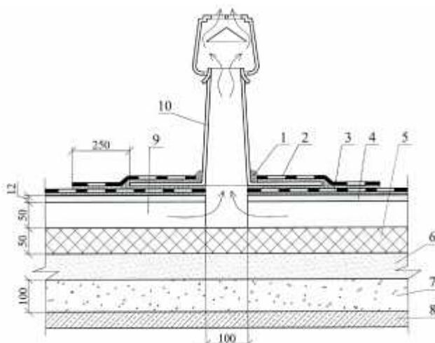
1 – герметик; 2 – дополнительный слой водоизоляционного ковра; 3 – основной слой ковра; 4 – сборная стяжка из ЦСП; 5 – минераловатные плиты; 6 – монолитная (существующая) стяжка; 7 – увлажненный пенобетон; 8 – железобетонная несущая плита; 9 – вентилируемый канал; 10 – аэратор 100 мм
