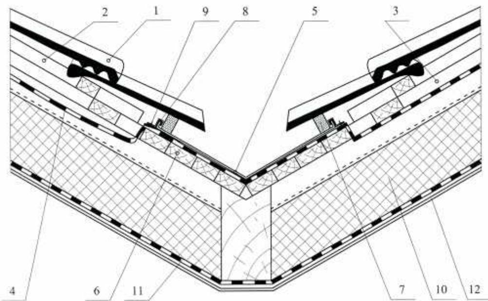
1 – черепица; 2 – обрешетка; 3 – контробрешетка; 4 – гидрозащитная пленка; 5 – алюминиевый окрашенный желобок; 6 – сплошной дощатый настил ендовы; 7 – поролоновая полоса; 8 – скоба крепления желоба; 9 – оцинкованный гвоздь; 10 – утеплитель с покровным (ветрозащитным) слоем; 11 – пароизоляция; 12 – внутренняя обшивка
