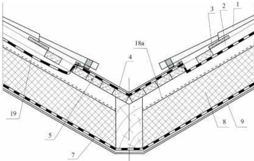
1 – металличерепица; 2 – контробрешетка; 3 – обрешетка; 4 – лист водоотводящего желоба; 5 – сплошной настил; 6 – гидроизоляционная пленка; 7 – пароизоляция; 8 – теплоизоляция; 9 – гипсокартон
