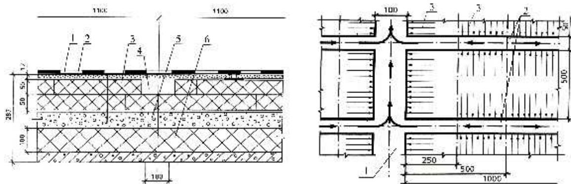
1 – новый кровельный ковер; 2 – сборная стяжка из ЦСП; 3 – минераловатные плиты; 4 – вентилируемые каналы; 5 – существующая стяжка из цементно-песчаного раствора; 6 – увлажненный пенобетон
