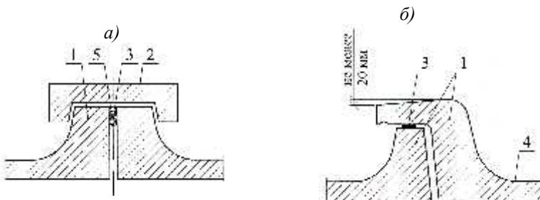
*а – стык с перекрытием П-образным нащельником; б – стык внахлестку; 1 – кровельная панель; 2 – П-образный нащельник; 3 – герметик; 4 – основная водосливная поверхность кровельных панелей; 5 – уплотнитель*
