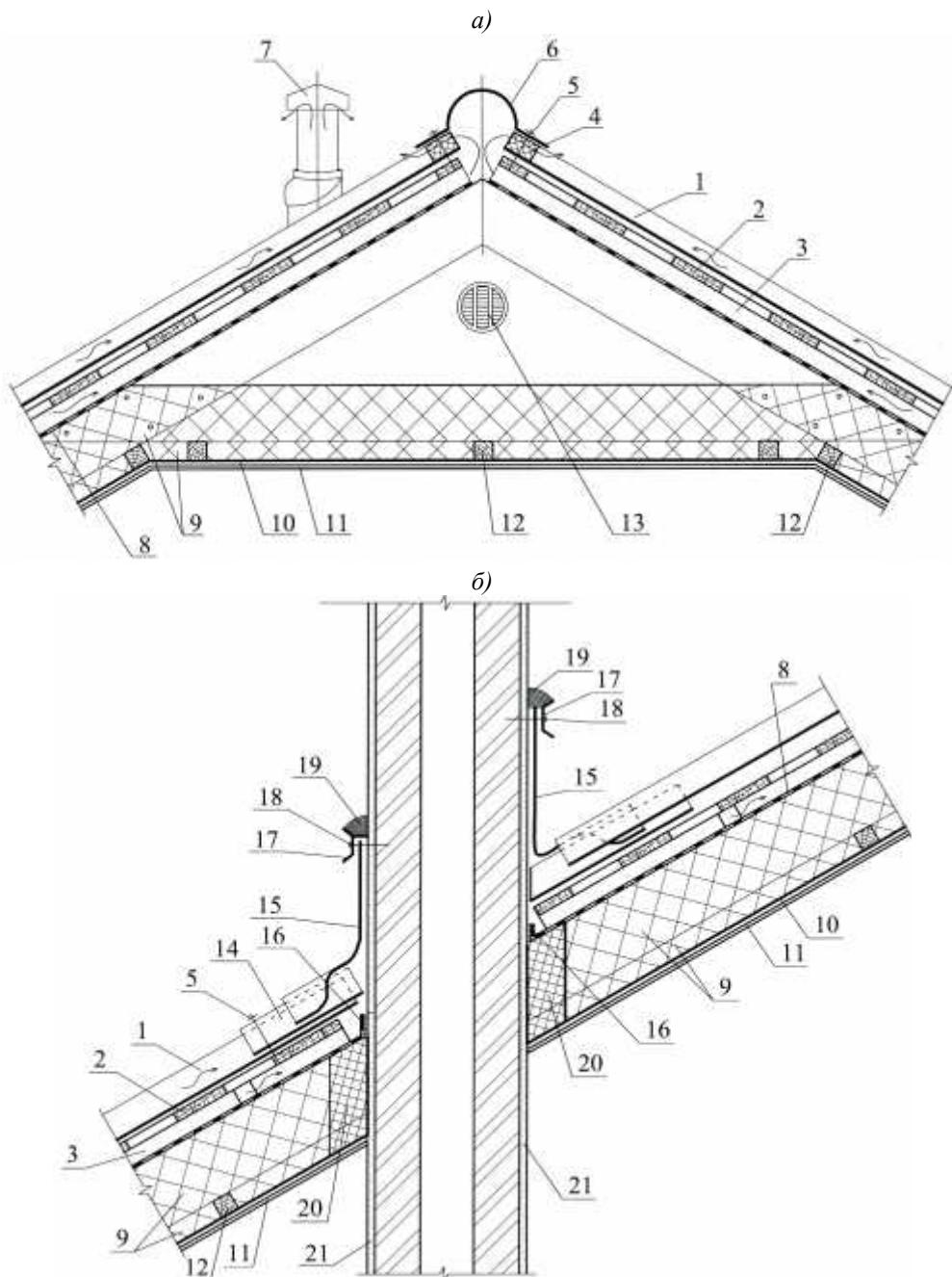
1 – волнистый лист; 2 – обрешетка; 3 – контробрешетка; 4 – уплотнитель без вентиляционных отверстий; 5 – гвоздь с закрывающейся шляпкой; 6 – коньковый элемент; 7 – венттруба; 8 – ветро-гидрозащитная пленка; 9 – теплоизоляция; 10 – пароизоляция; 11 – гипсокартон; 12 – брусков; 13 – щипцовое окно; 14 – фартук; 15 – вертикальная часть фартука; 16 – герметизирующая лента; 17 – металлическая планка; 18 – дюбель; 19 – герметик; 20 – минвата (негорючая); 21 – кирпичная труба
