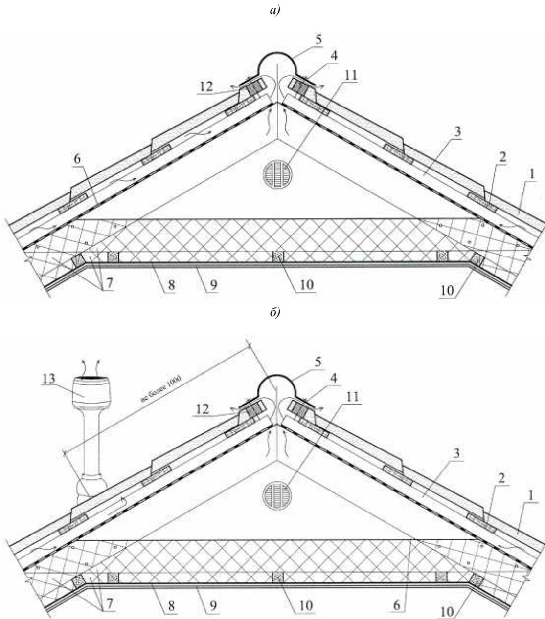
1 – металлическая черепица; 2 – обрешетка; 3 – контробрешетка; 4 – гвоздь с закрывающейся шляпкой; 5 – коньковый элемент; 6 – ветрогидрозащитная пленка; 7 – теплоизоляция; 8 – пароизоляция; 9 – гипсокартон; 10 – брусков; 11 – щипцовое окно; 12 – уплотнитель; 13 – вытяжка
