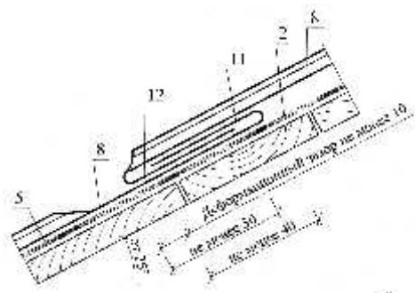
*а* – на кровлях с уклоном от 5 до 9° (9 – 16 %); *б* – на кровлях с уклоном от 10 до 24° (18 – 45 %); *в* – на кровлях с уклоном от 25° (47 %); 1 – стропило; 2 – обрешетка; 3 – доборный брус; 4 – доска; 5 – объемная диффузионная мембрана; 6 – костьль; 7 – металлическая полоса; 8 – кровля из металлических листов; 9 – фальшпланка; 10 – припой; 11 – загнутый край нижней картины; 12 – загнутый край верхней картины
