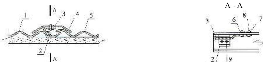
1 – накрываемый край волнистого листа; 2, 3 – скоба; 4 – лотковая деталь; 5 – край волнистого листа; 6, 7 – шайбы; 8 – винт с полукруглой головкой; 9 – заклепка
