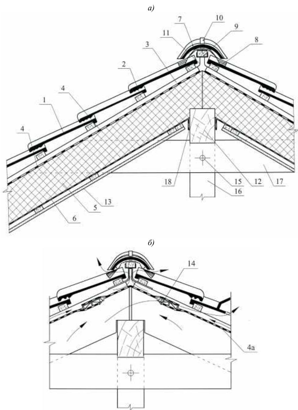
1 – черепица; 2 – обрешетка; 3 – контрольная решетка; 4 – ветроизоляционная пленка; 4а – гидроизоляционная пленка; 5 – утеплитель; 6 – пароизоляция; 7 – коньковая черепица; 8 – аэроэлемент конька; 9 – коньковый бруск; 10 – зажим коньковой черепицы; 11 – крепление конькового бруска; 12 – коньковый прогон; 13 – внутренняя обшивка; 14 – вентиляционный элемент; 15 – болтовое соединение; 16 – столб; 17 – ригель; 18 – приклейка пароизоляции
