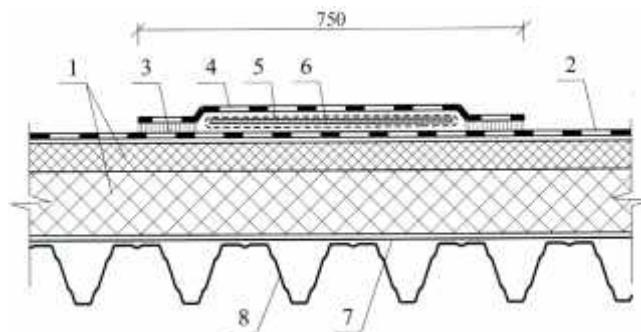
1 – плитный утеплитель; 2 – основной водоизоляционный ковер из ПВХ- или ТПО-мембранны; 3 – сварной шов шириной 30 мм; 4 – дополнительный слой водоизоляционного ковра из ПВХ- или ТПО-мембранны; 5 – защитный слой из геотекстиля плотностью не менее 350 г/м<sup>2</sup>; 6 – влагостойкая антисептированная фанера толщиной 12 мм; 7 – пароизоляция; 8 – несущий профнастил
