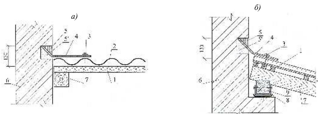
1 – обрешетка; 2 – лист; 3 – гвоздь (шуруп); 4 – уголковая деталь; 5 – герметик; 5' – цементно-песчаный раствор; 6 – стена; 7 – стропило; 8 – гидроизоляция из рулонного материала; 9 – маэрлат
