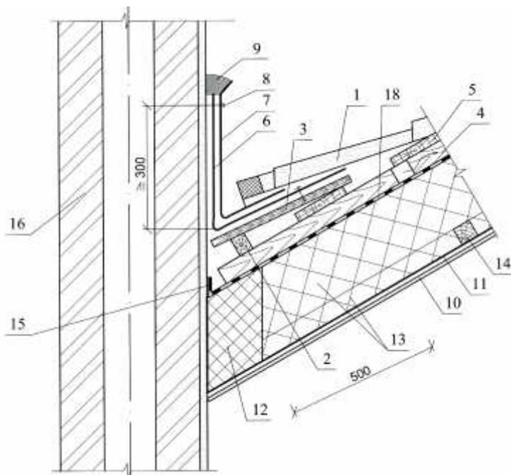
1 – металличерепица; 2 – бруск; 3 – деревянный настил; 4 – контробрешетка; 5 – обрешетка; 6 – битумный самоклеящийся рулонный материал; 7 – металлическая деталь; 8 – дюбель; 9 – герметик; 10 – гипсокартон; 11 – пароизоляция; 12 – минвата (негорючая); 13 – теплоизоляция; 14 – бруск; 15 – крепление ветрогидрозащитной пленки двухсторонней липкой лентой; 16 – труба; 18 – ветро-гидроизоляционная пленка; 18а – ветрозащитный слой (из стеклохолста); 19 – гидрозащитная пленка
