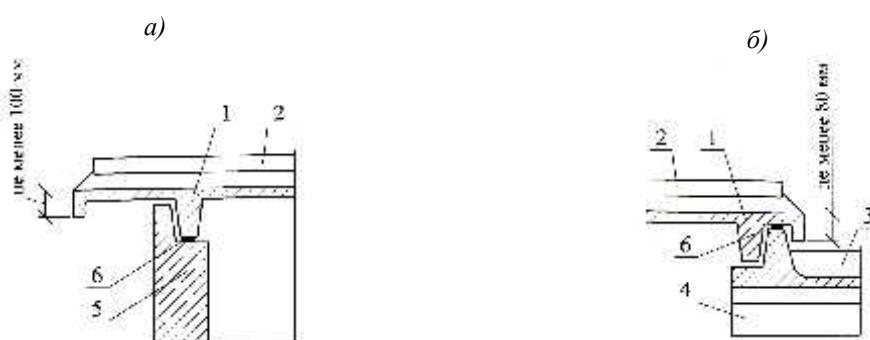
*1 – кровельная панель; 2 – П-образный нащельник; 3 – водосборный лоток; 4 – подкладочная балка под водосборный лоток; 5 – парапетная фризовая панель; 6 – герметик*
