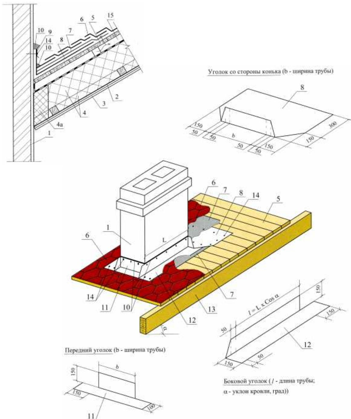
1 – труба; 2 – гипсокартон; 3 – пароизоляция; 4 – теплоизоляция; 4а – негорючий утеплитель; 5 – настил; 6 – битумная черепица; 7 – рулонный материал; 8 – уголок со стороны конька; 9 – металлическая планка примыкания; 10 – герметик; 11 – передний уголок; 12 – боковой уголок; 13 – стропило; 14 – крепежный элемент; 15 – вентиляционный канал; 16 – ветрогидрозащитная пленка.
