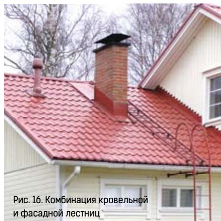
Рис. 16. Комбинация кровельной и фасадной лестниц
