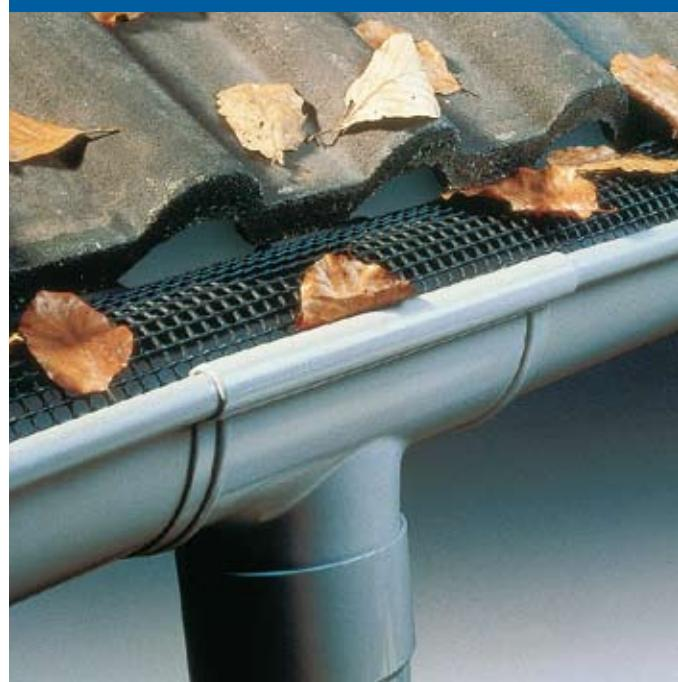
Просто положите **Marley Poly-Net Laubstop** в водосточный желоб – и у листьев не будет больше никаких шансов. Она остается лежать на круглой поверхности, высохнет и ее унесет ветер. Marley Poly-Net Laubstop из полиэтилена (ПЭ) – прочная, коррозионностойкая, температуростойкая и на 100 % утилизуемая. Для водосточных желобов RG 150-180, RG 100-125 и прямоугольных водосточных желобов (до RG 100).
