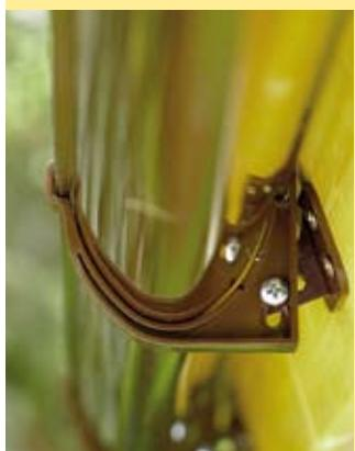
Происходит так: регулируемые опоры желоба Marley Вы сначала привинчиваете, а потом настраиваете наклон и уклон. Это существенно облегчает установку. При монтаже на ветровой доске опора для желоба компенсирует наклон до 25°. Максимальное расстояние между держателями водосточных желобов Дуплекс и прямоугольных желобов составляет 50 см!
