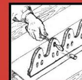
Заполнитель может быть вентилируемым или невентилируемым. Необходимость вентиляции определяется конструкцией каждой кровли. Если заполнитель должен быть вентилируемым, освободите вентиляционные отверстия, например, отверстием. Чем больше отверстий вы освободите, тем лучше будет вентиляция.
