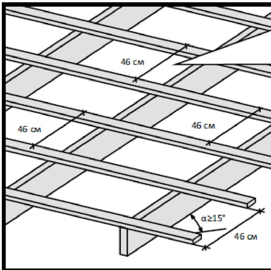
При угле наклона крыши от  $15^\circ$  (уклон от 1/4) делается обрешетка из доски или бруса с интервалом 46 см.
