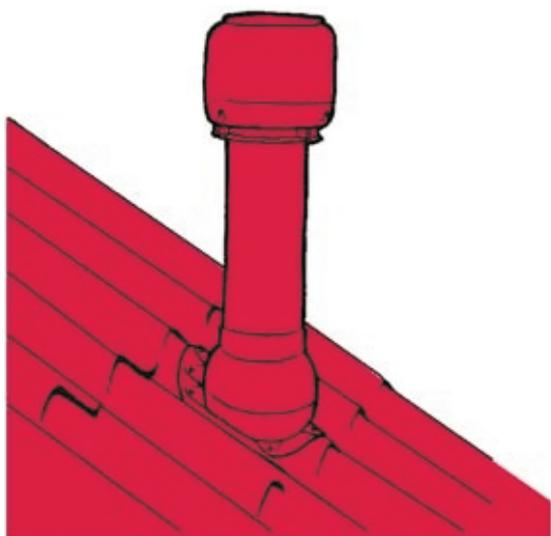
Трубы вытяжки, оснащенные вентиляторами, используются в системах вентиляции, идущих от кухонного надплитного вытяжного зонта. Такой вентилятор может быть также подсоединен к системе плавной регулировки работы вытяжного зонта.
