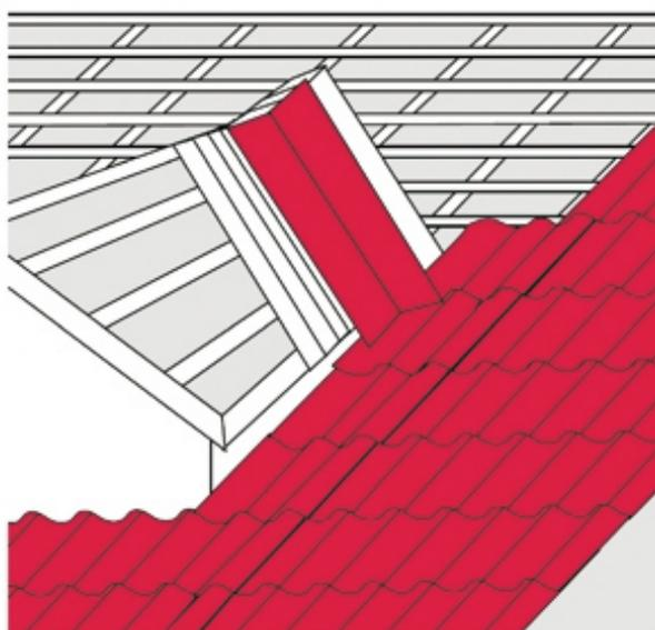
2. Затем разметьте и обрежьте края планки ендовы и установите ее на кровлю, таким образом, чтобы ее нижний край был сверху нижнего кровельного листа.
