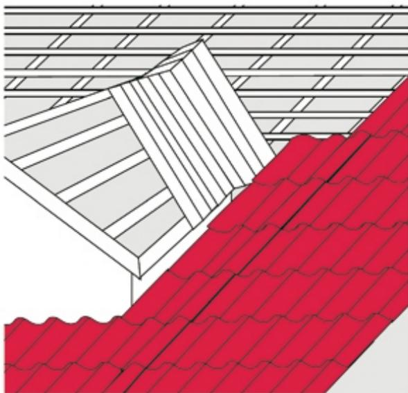
• **Установка ендов, не выходящих за пределы ската крыши**
