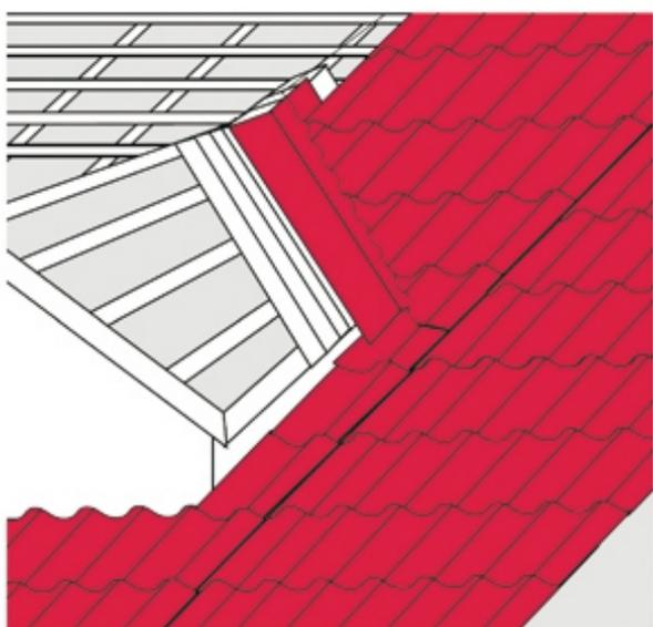
3. Далее разметьте и вырежьте верхний кровельный лист так, чтобы он оптимально совпадал с очертаниями слухового окна, и установите его на место. При этом верхний кровельный лист должен быть установлен как сверху планки ендовы так и сверху нижнего кровельного листа.
